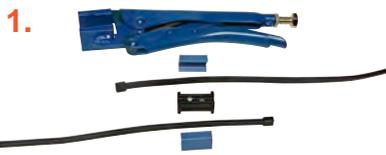
Flachkabel (2x0,75mm<sup>2</sup>) in den DC-Verbinder einlegen. Montagehülse aufsetzen.
