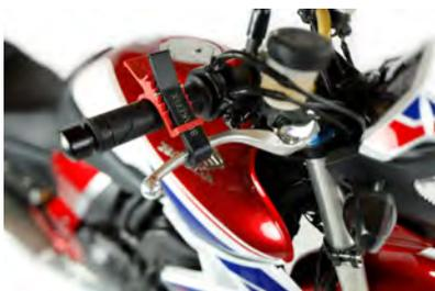
Das Brakefix wird an Handbremshebel + Lenker montiert und so wird die Vorderradbremse blockiert. Nun ist sicheres Parken + zuverlässiger Transport garantiert!
